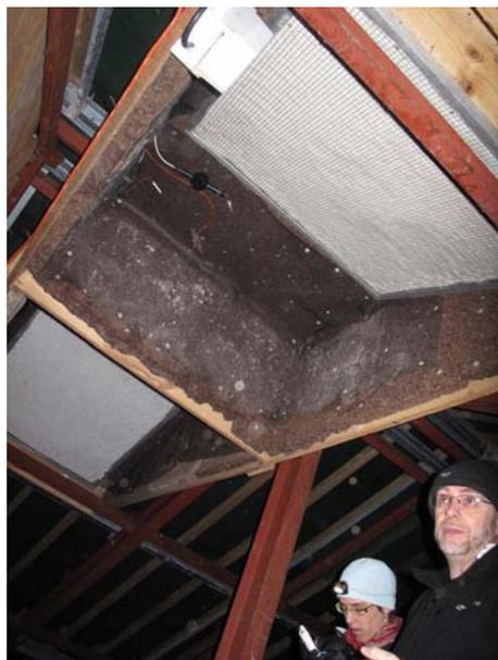
Hot box équipée d'une couverture chauffante industrielle (© D. Storms)
